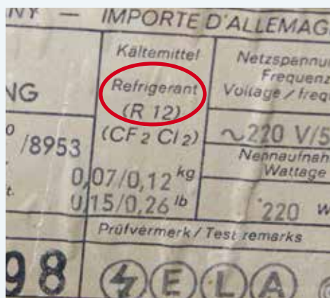
Figura 11: Indicación del tipo de refrigerante en el etiquetado del producto (izquierda) y en el compresor (derecha)
