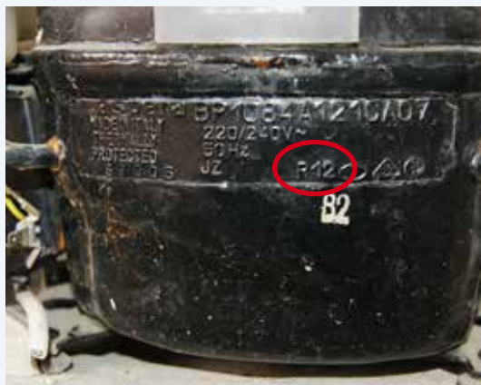
Figura 11: Indicación del tipo de refrigerante en el etiquetado del producto (izquierda) y en el compresor (derecha)
