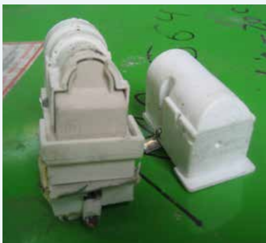
Figura 5. Las piezas que contienen mercurio (derecha) a menudo se encuentran detrás de la lámpara en la cubierta de la parte superior de congeladores horizontales (izquierda).
