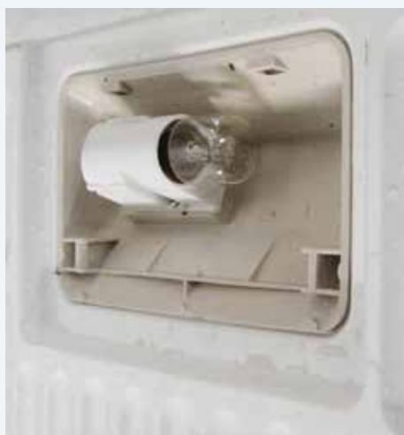
Figura 5. Las piezas que contienen mercurio (derecha) a menudo se encuentran detrás de la lámpara en la cubierta de la parte superior de congeladores horizontales (izquierda).
