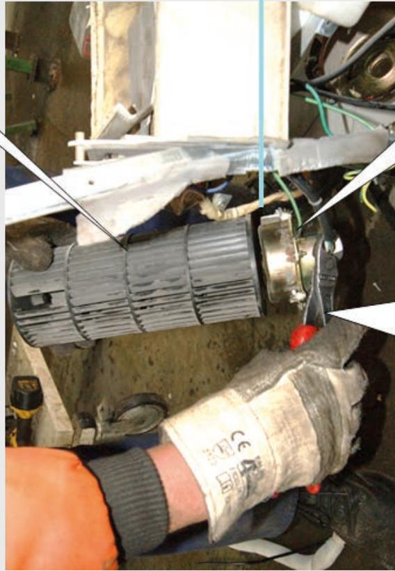
Кусачки, для отделения электромотора/ вентилятора
