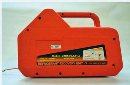
Рисунок А: Широко используемые портативные установки для сбора хладагента (слева: вид сбоку, справа: вид спереди). Данная установка не содержит встроенного масляного сепаратора.
