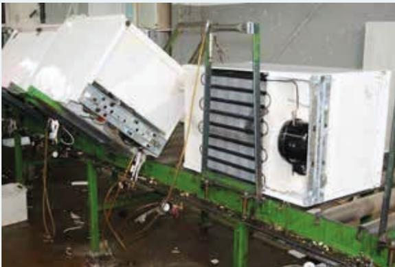
Разборочный конвейер для извлечения хладагента с использованием щипцов-проколки
