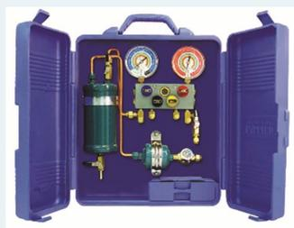
Рисунок С: Инструмент для удаления масел, примесей и влаги в качестве приложения к обычной установке сбора хладагента, как на Рисунке А
